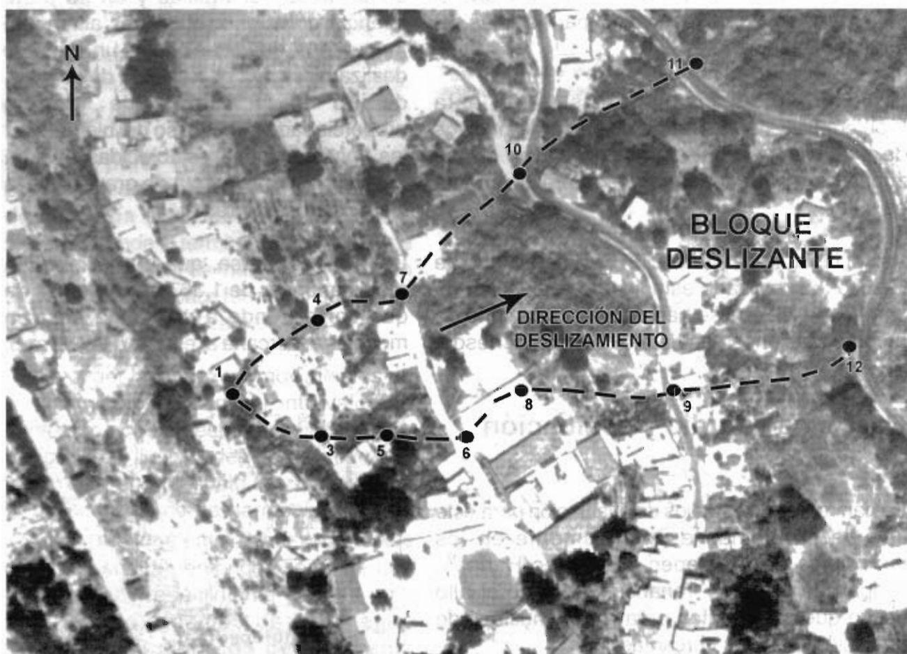
Figura 4. Zona de deslizamiento en la cabecera municipal de Amatepec, México. Fotografía aérea que muestra la ubicación de los puntos de monitoreo (círculos grises) en los cuales se colocaron pares de postes de concreto de 1.20 m de largo y 0.20 m de diámetro
